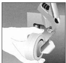
A l'aide d'un niveau, vérifier que les roulettes sont fixées à la même hauteur. Si tel n'était pas le cas, la porte risque de ne pas fermer correctement. La mise de niveau peut être effectuée à l'aide d'une rondelle insérée entre le bas du meuble et la roulette.
